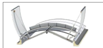
Sous forme de clapet double symétrique
