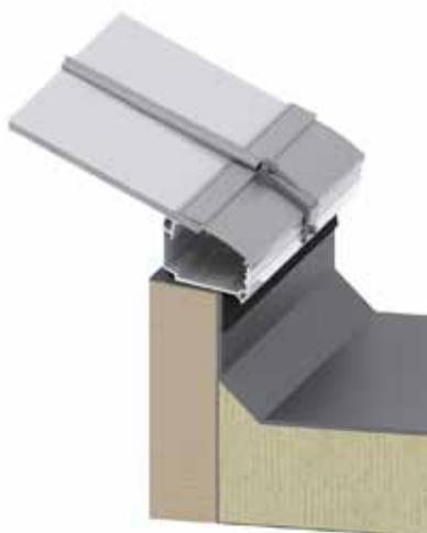
Montage sur un relevé en béton
