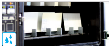
Essai à l'humidité
