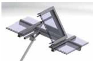
Clapet simple sur toit plat
