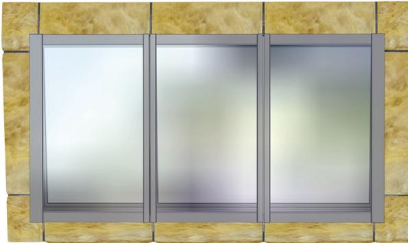
Umlaufende Ausdämmung von Rahmensystem bis Ende der Unterkonstruktion.
