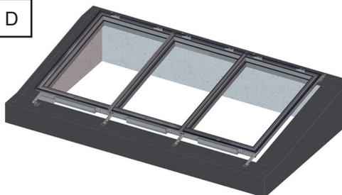
Verbundene Basisrahmen-Konstruktion über dem Dachausbruch der Unterkonstruktion ausmitteln. (Die gegenüberliegenden Seiten müssen den gleichen Randabstand haben.)
