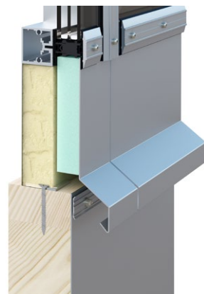
Montage vertical sur un relevé en bois
