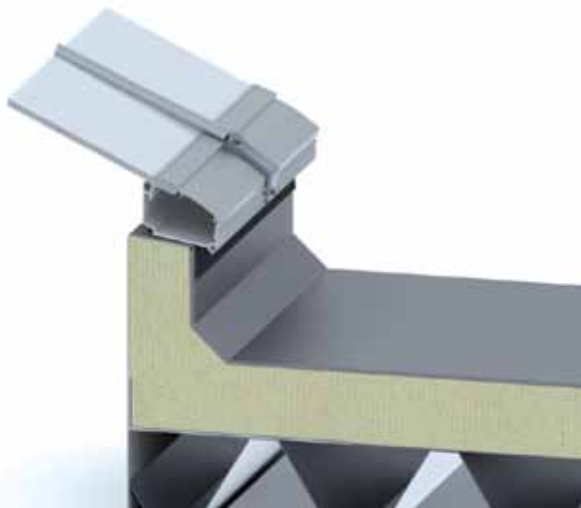
Montage sur costière en tôle d'acier
